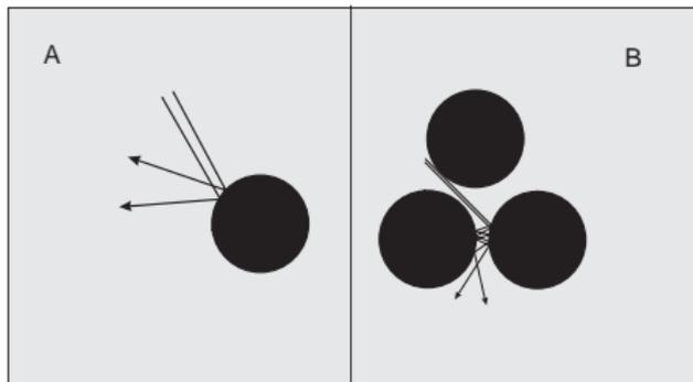
Dicke Nägel (schwarze Kreise), kleine Kugeln: A: Zwei **anfänglich nahe** beieinander liegende Einfallsbahnen werden durch den Stoß mit der runden Nagelfläche aufgetrennt.
